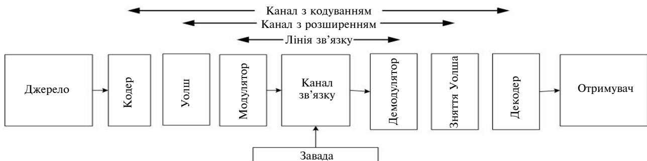
Рис. 3. Модель системи передачі дискретної інформації
