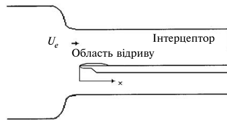
Рис. 1. Низькошвидкісна аеродинамічна трубка відкритого типу
